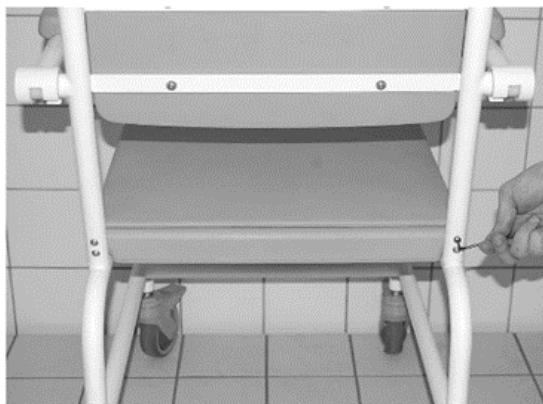
**DK:** De medfølgende skruer spændes ved hjælp af en unbrakonøgle. Sørg for at skruerne er spændt godt fast for at sikre sig, at ryggens stabilitet er sikker. Husk at efterspænde ryggen efter ca. 1 måned. Skruerne skal kasseres ved afmontering, og der skal benyttes nye skruer ved næste på montering.
